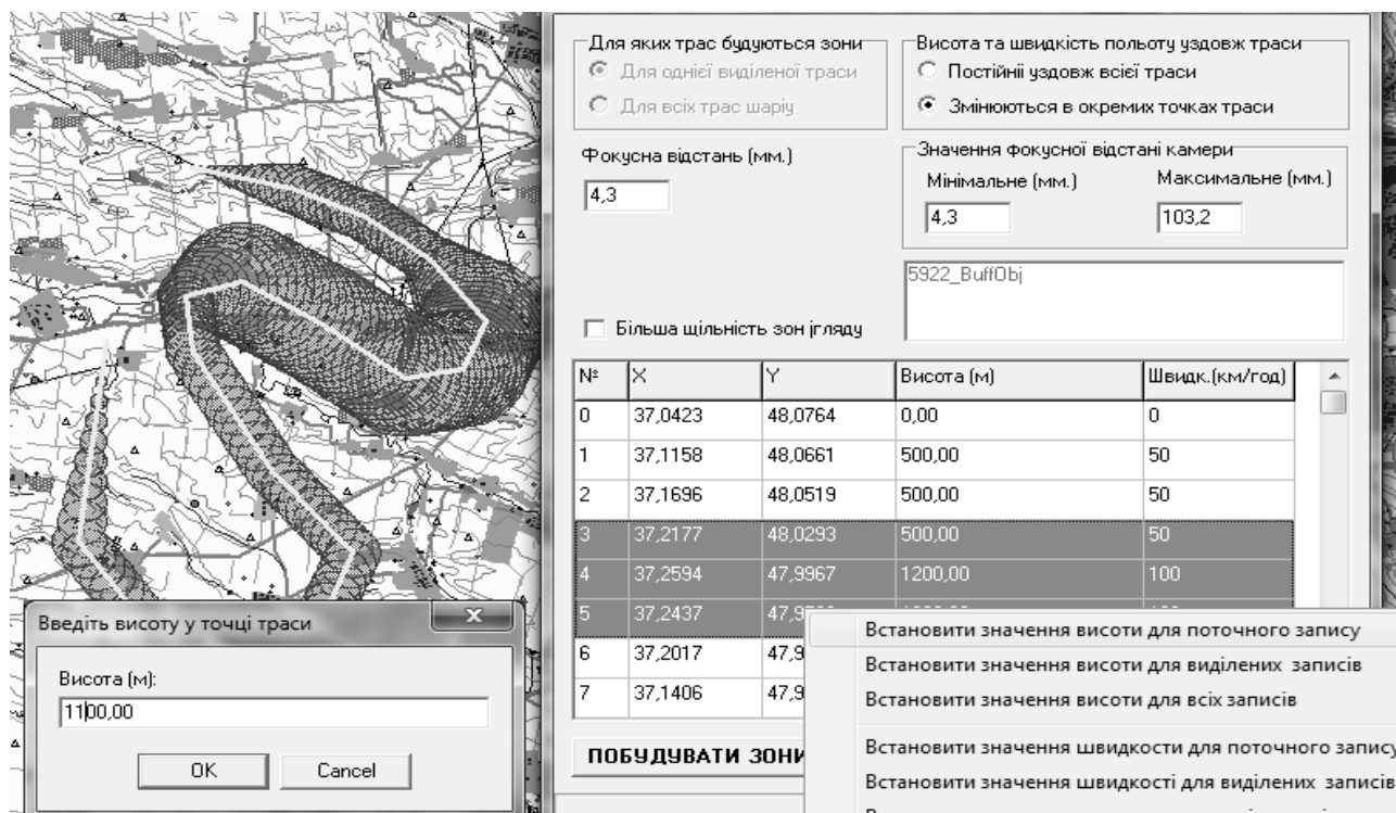
Рисунок 2. Вигляд зони видимості на карті з огляду на умови змінної висоти польоту вздовж траси БПЛА
